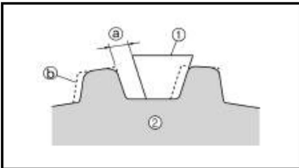
**Camshaft sprockets inspection**
