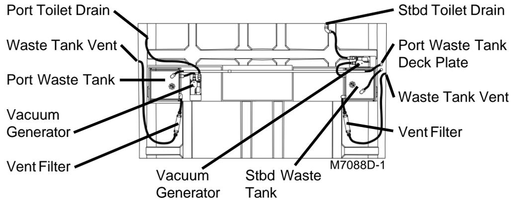
**SANITATION SYSTEM - OVERBOARD DISCHARGE**
